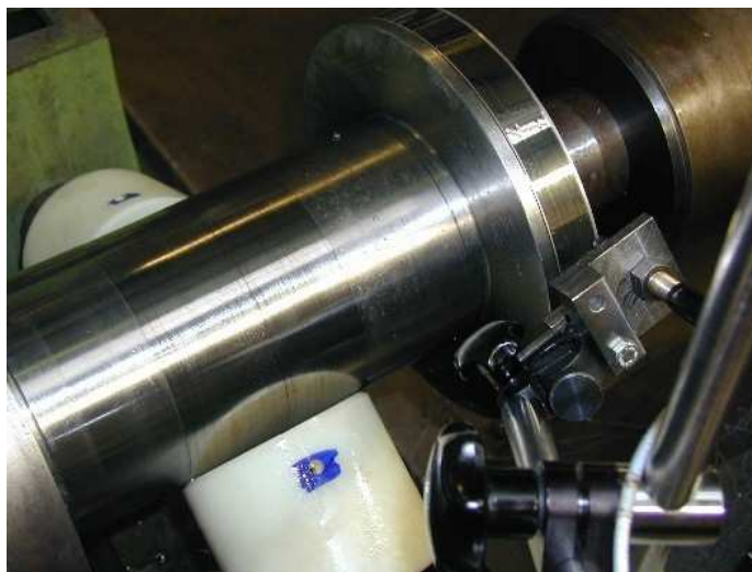
Рисунок 10 - Установка системы измерения: ротор поддерживается на тефлоновых V-блоках, датчик установлен на очень жестком фиксаторе
